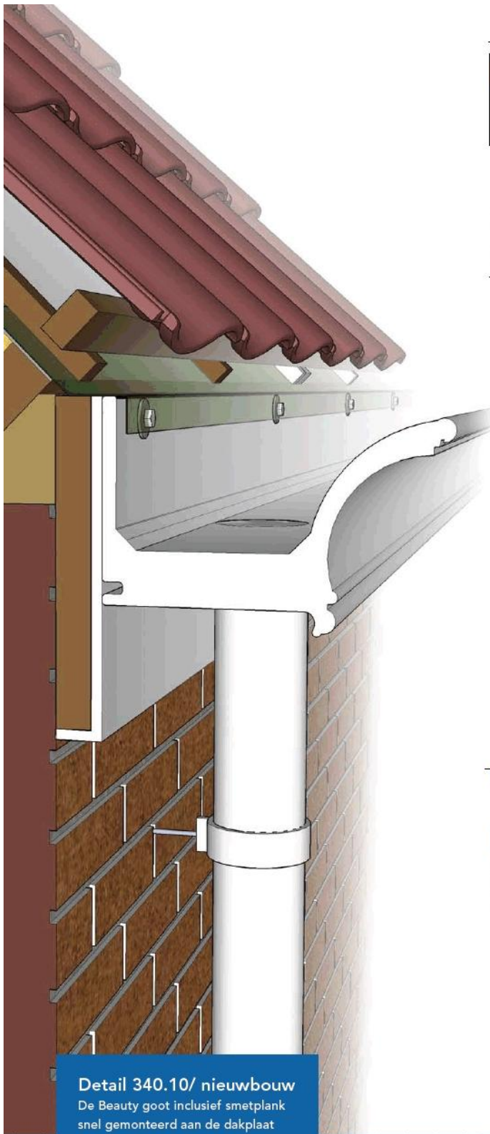
Detail 340 dubbel De Beauty goot twee keer uitge- voerd inclusief smetplank met variabele maat aan de achterzijde.
