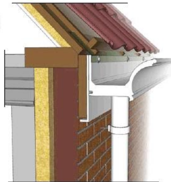
Detail 340.11/ renovatie De Beauty goot inclusief smetplank als renovatiedetail direct aan de muurplaat bevestigd.
