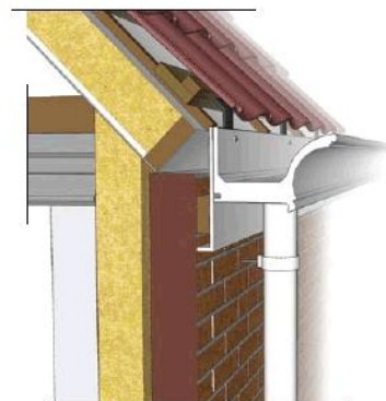
Detail 340.31 De Beauty goot inclusief smetplank direct aan de gootplank gemonteerd m.b.v. gootbeugel.
