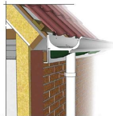
Detail 200.31 De Rustieke goot inclusief smetplank en gootklossen direct aan de gootplank gemonteerd m.b.v. gootbeugel.
