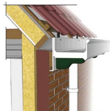
Detail 160.31 De Klassieke goot inclusief smetplank en gootklossen direct aan de gootplank gemonteerd m.b.v. gootbeugel.
