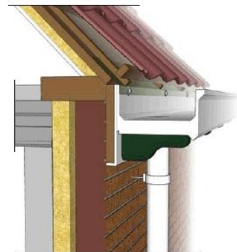
Detail 160.11/ renovatie De Klassieke goot inclusief smetplank en gootklossen als renovatiedetail direct aan de muurplaat bevestigd.
